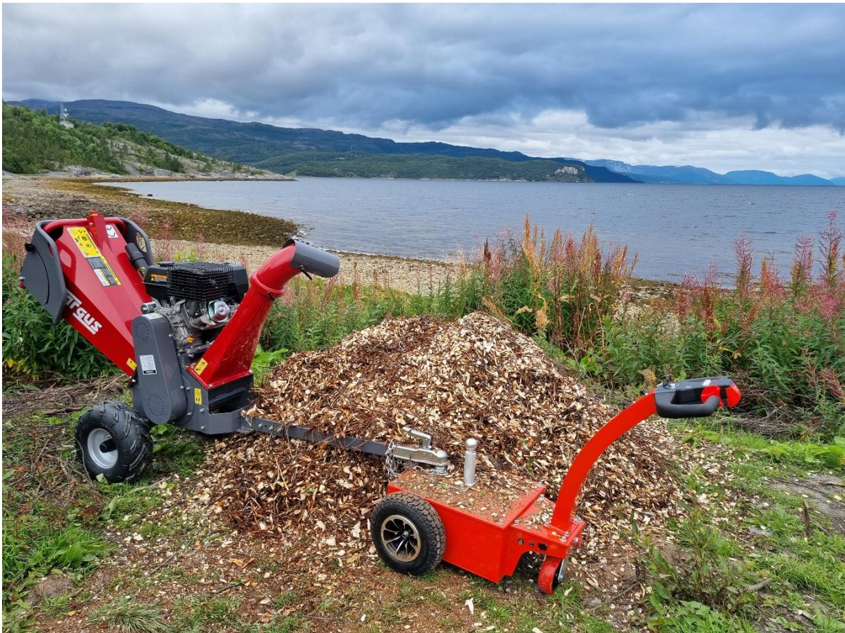
Figur 1: Med my fliskutter er opprydding etter skogsarbeid svært mye enklere og mer effektivt. Vi slipper sjenerende kvisthauger i området, og vi kan utnytte flisa ved behov. I år testet vi blant annet ut markdekke langs gangveien. Foto. R. Normann.
